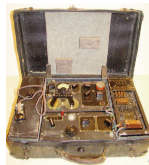
Emetteur-récepteur de type B Mk II, dans sa valise de camouflage (32 x 42 x 14 cm, 13, 2 kg), utilisé par le SOE à partir de 1942. (collection privée).
